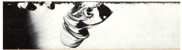
Eksempel på kantskade som følge av påført skade.
