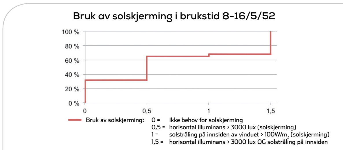
Figur 11: Varighet for bruk av solskjerming i brukstid 8-16 hverdager hele året basert på resultater fra IDA ICE 4.5 og DAYSIM.
